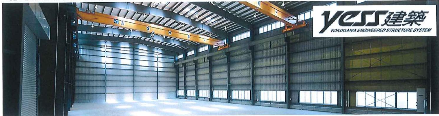
yess建築(Yokogawa Engineered Structure System)は、システム建築のトップメーカーである横河システム建築が、システム建築のコンセプトを独自の技術で構築し、日本で唯一の「システム建築専用工場 横河システム建築千葉工場」で製造されるシステム建築です。建物の構成要素となる「鉄骨」「屋根」「外壁」「建具」等に関する部材ディテールや配置を徹底した標準化と軽量化を図ることにより、「短工期」「低価格」「高品質」「大空間」を実現しています。
